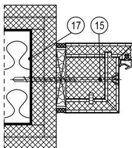
X-Maß: Mauerwerk, Beton  $\geq 50,0$  mm / Porenbeton T30, T90  $\geq 87,5$  mm / Porenbeton T30, RS  $\geq 57,5$  mm bis 100 kg Türgewicht / Porenbeton RS  $\geq 75,0$  mm
