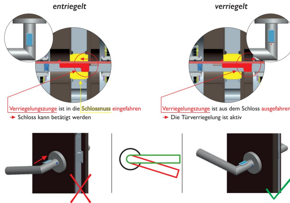
**Achtung** Ent- und Verriegelung der Türe nur bei horizontal stehendem Drücker möglich. Für den Fall, dass dies nicht durch die integrierte Federtechnik erfolgt, bitte den Drücker manuell in die entsprechende Position bringen.
