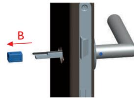
**Achtung:** Dabei kann es passieren, dass die obere Verriegelungszunge leicht aus dem Schloss wieder herausgezogen wird. Diese Zunge muss dann mit dem Montagewerkzeug wieder nach innen geschoben werden bis der Anschlag an der Schlossnuss anliegt.
