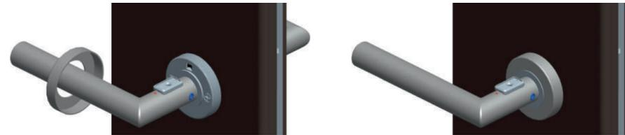
10 Montieren Sie nun die Abdeckung des Verriegelung-Schiebers. Ziehen Sie dazu das Klebeband ab.
