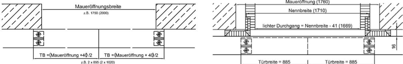
**Hinweis:** Wenn die Türblätter komplett vor die Wand geschoben werden und die Bodenführungen nicht überstehen sollen, dann ist die Türblattbreite wie folgt zu wählen: TB = Lichter Durchgang/2 + mind. 50mm (Länge der Bodendichtung 50 mm).
