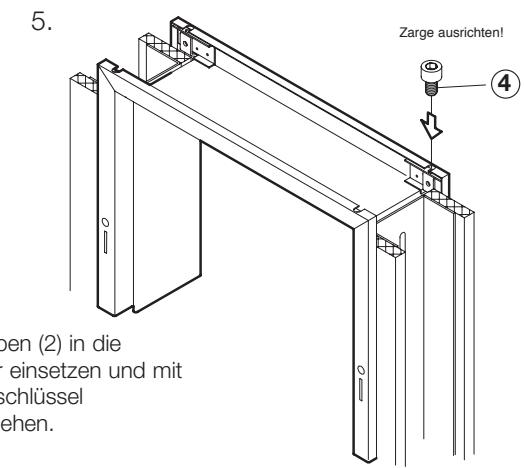
5. Inbusschrauben (2) in die Eckverbinder einsetzen und mit einem Inbusschlüssel (5 mm) festziehen.
