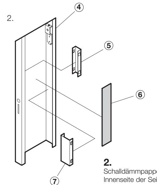
2. Schalldämmppappe (6) auf die Innenseite der Seitenteile (1+4) aufkleben, Distanzbleche (5) hinter den Spiegel A (Falzseite) und Distanzbleche (7) hinter den Spiegel B (Falzgegenseite) der Seitenteile (1+4) festklemmen.
