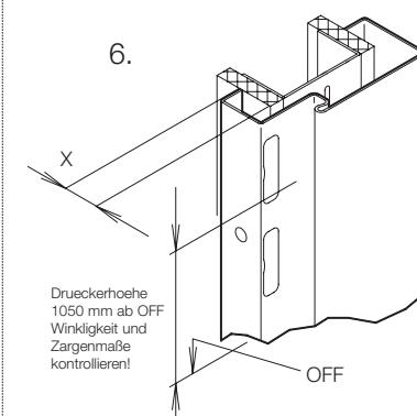
6. Stahlzarge ausrichten und Meterrissmarkierung auf 1000 mm über OFF setzen. Winkeligkeit überprüfen! Darauf achten, dass der Spiegel je Seite 15 mm (X) die Wand umgreift. Zargenfalzmaß von oben nach unten auf Gleichmäßigkeit nachmessen.
