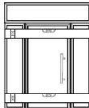
Richtige Anordnung der Schrauben, die das Oberlicht und Seitenteile mit dem Türrahmen verbinden
