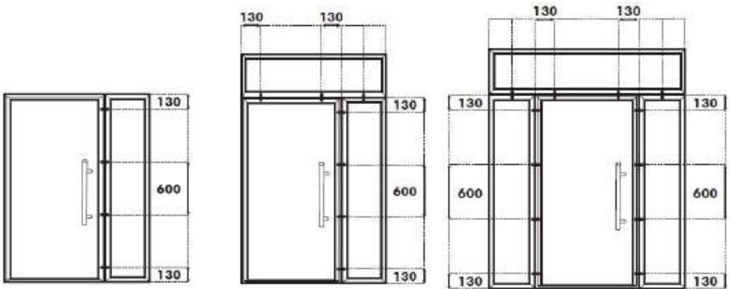
4.3 Die Montage des Türrahmens mit den Lichtern erfolgt genauso, wie beim Türrahmen selbst. Den Rahmen des Lichts kann man genauso wie beim Türrahmen mit Montageankern oder Dübeln montieren.
