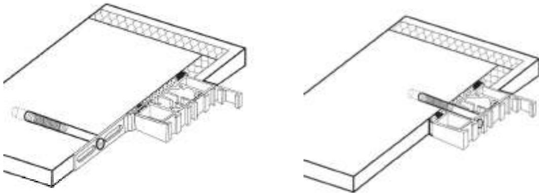
4.4 Nach der Montage der Rahmen und Aufhängen des Türflügels ist die Glasscheibe des Lichts wieder einzusetzen, wobei man in der umgekehrten Reihenfolge vorgeht, d.h. die Glasscheibe einsetzen, die Wärmesperre einlegen, Leisten (1) und Dichtung (2) montieren.
