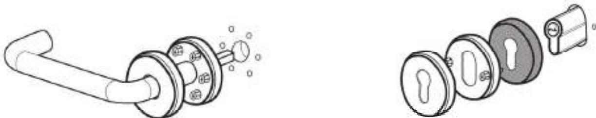
**ACHTUNG : der Vierkant -Bolzen sollte am Drücker genau laut unterer Zeichnung montiert werden . Den Vierkant wie unten mit der Schraube befestigen**
