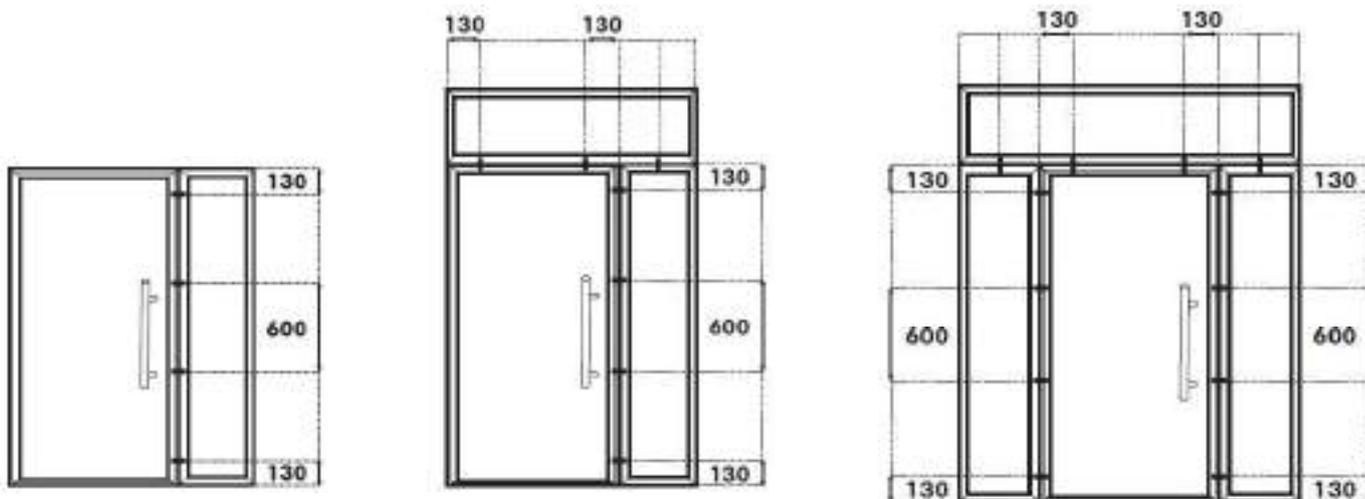
6.3 Die Montage des Türrahmens mit den Lichtern erfolgt genauso, wie beim Türrahmen selbst. Der Türrahmen wird in eine überprüfte und vorbereitete Öffnung eingebaut – der Türflügel ist vorher abzunehmen. Die Montage erfolgt mittels Dübeln. Die Montagelöcher sind im Rahmen zu bohren; der Durchmesser ist den Dübeln anzupassen
