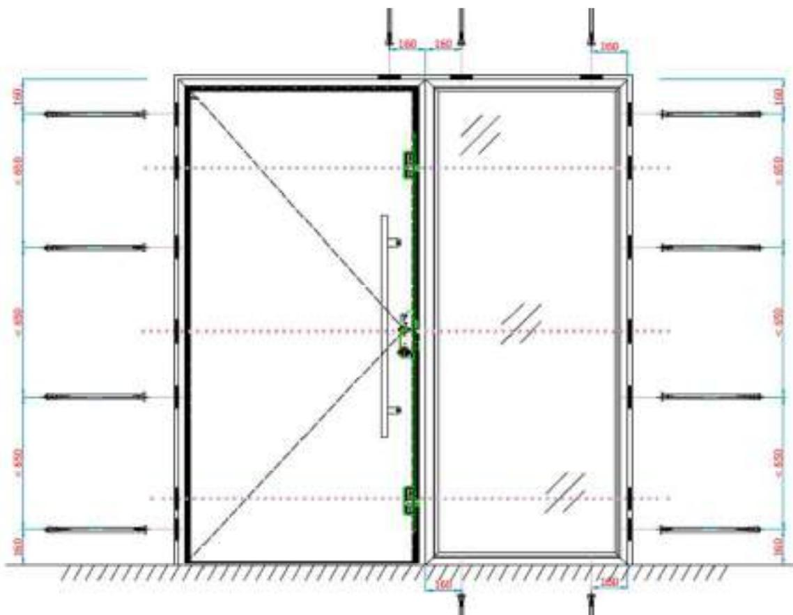
Der Türrahmen ist in die Öffnung in der Mauer zu stellen und mit Distanzklötzchen wie in der Abb.1 horizontal und vertikal auszurichten. Die Distanzklötzchen dürfen nicht entfernt werden. Der so gestellte Rahmen ist an die Mauer mit Dübeln oder mit Montageanker zu befestigen. Bei den Montageanker müssen diese immer innen und außen montiert werden
