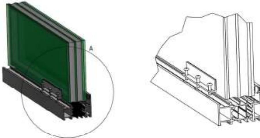
6.2 Dann ist der Rahmen der Lichter mit dem Türrahmen zu verbinden, wobei das Verbindungsprofil (1) und der Dichtschnurr (3) anzusetzen sind. Auf der markierten Stelle sind Löcher für Verbindungsschrauben (2) zu bohren und die Lichter sind mit dem Türrahmen in den Abständen, die in der nächsten Abbildung angezeigt sind, zusammenzuschrauben.
