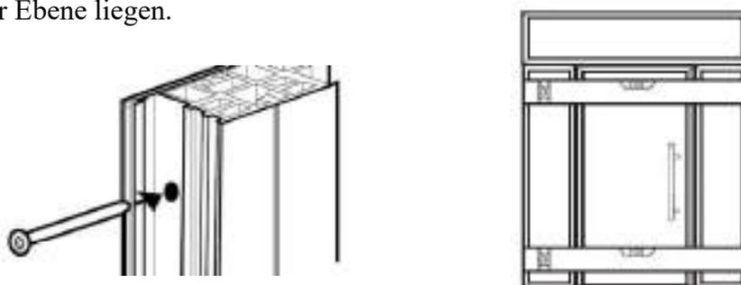
Richtige Anordnung der Schrauben, die das Oberlicht und Seitenteile mit dem Türrahmen verbinden
