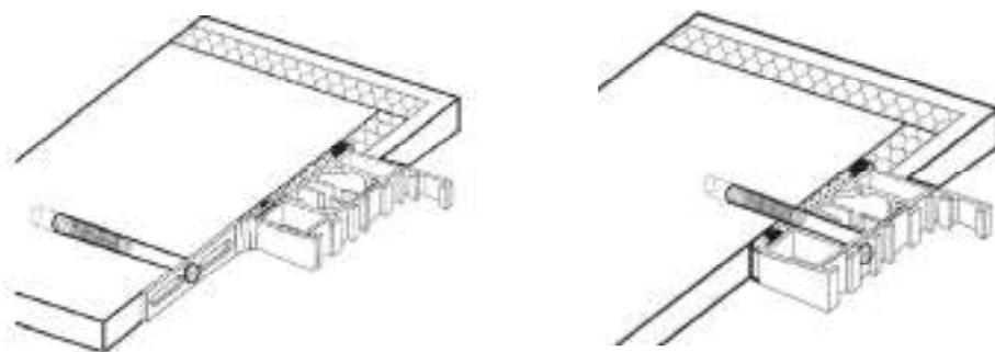
Nach dem Stand der Technik sollen die montierten Rahmen zusätzlich abgedichtet werden – von innen dampfdicht und von außen wasserdicht. Dazu können entsprechende Dichtbänder oder -massen benutzt werden, die auf der Rauminnenseite eine dampfdichte Verbindung des Rahmens mit der Mauer und von außen eine dampfdurchlässige aber wasserdichte Verbindung herstellen.
