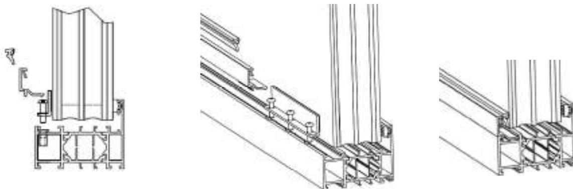
Leisten (1) und Dichtung (2) montieren.
