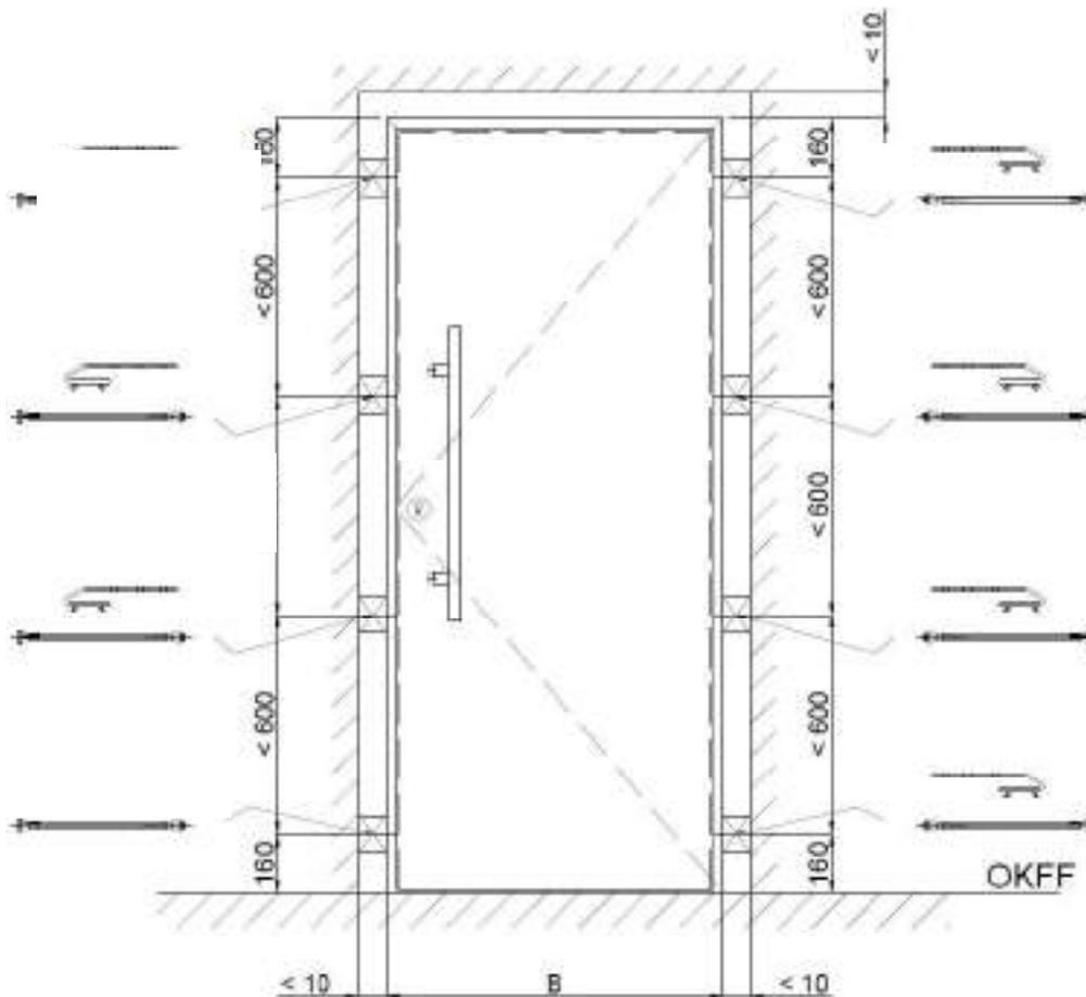
ist in die Öffnung in der Mauer zu stellen und mit Distanzklötzchen 1 horizontal und vertikal auszurichten – anfangend von der Scharnierseite. Dann sind die Diagonalen zu messen und die Tiefe der Lage des Rahmens in Bezug auf die
