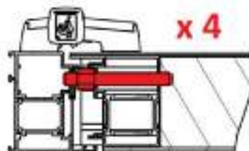
Aushebelbolzen an der Bandseite
