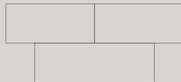
Bei der Verlegung **ohne Fase** schließen die Dielen ohne deutliche Zwischenräume aneinander an, was ein harmonisches Verlegebild erzeugt.
