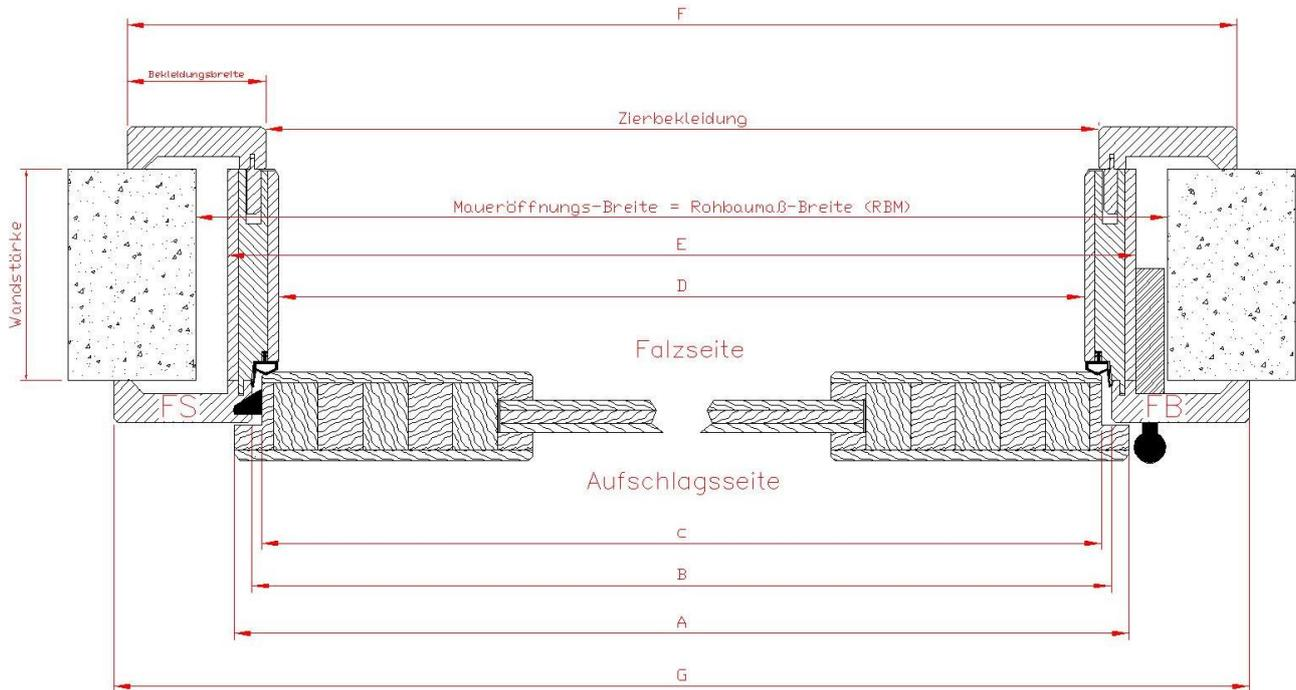
Längsschnitt inkl. Innentür Modell-Linie moderner Premium-Massivholztür
