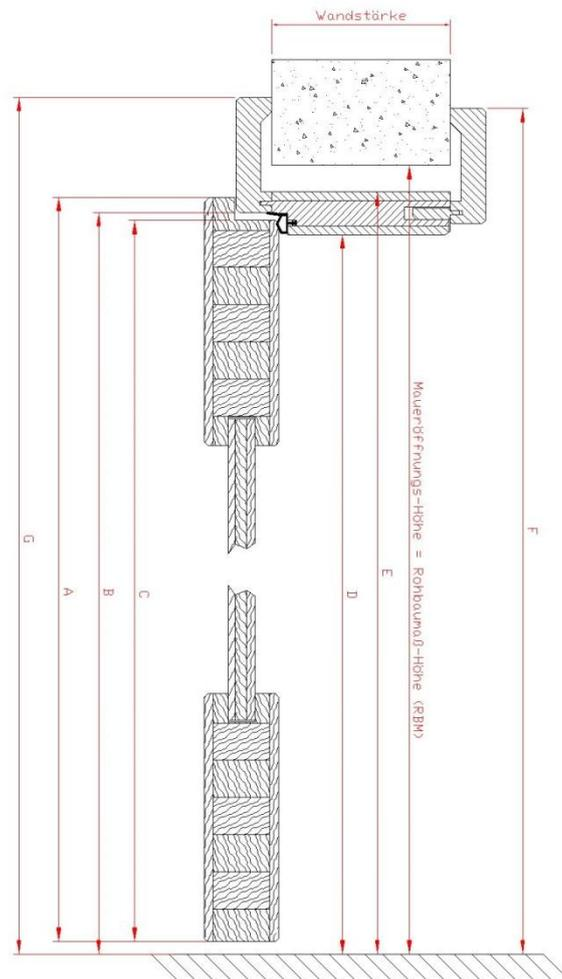
**Wandöffnungen nach DIN 18101 und Abmessungen am Türblatt für Moderne, gerade Massivholzzarge ohne Gehrung (Modell C)**
