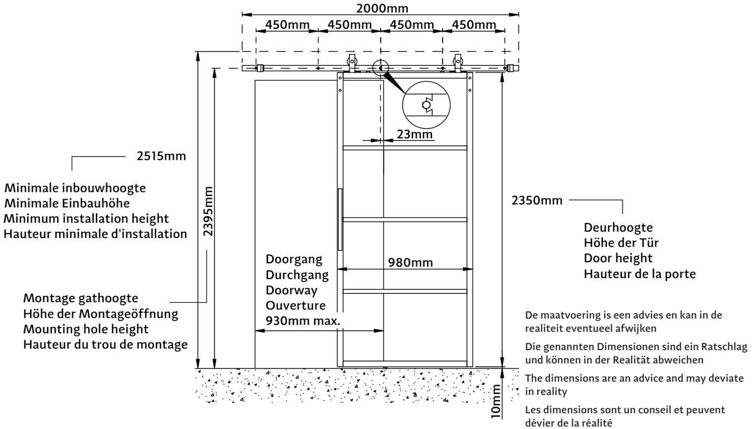
**-1A-** Montage op muur van steen/beton - Wand aus Stein/beton - Stone/concrete wall - Mur en brique/béton
