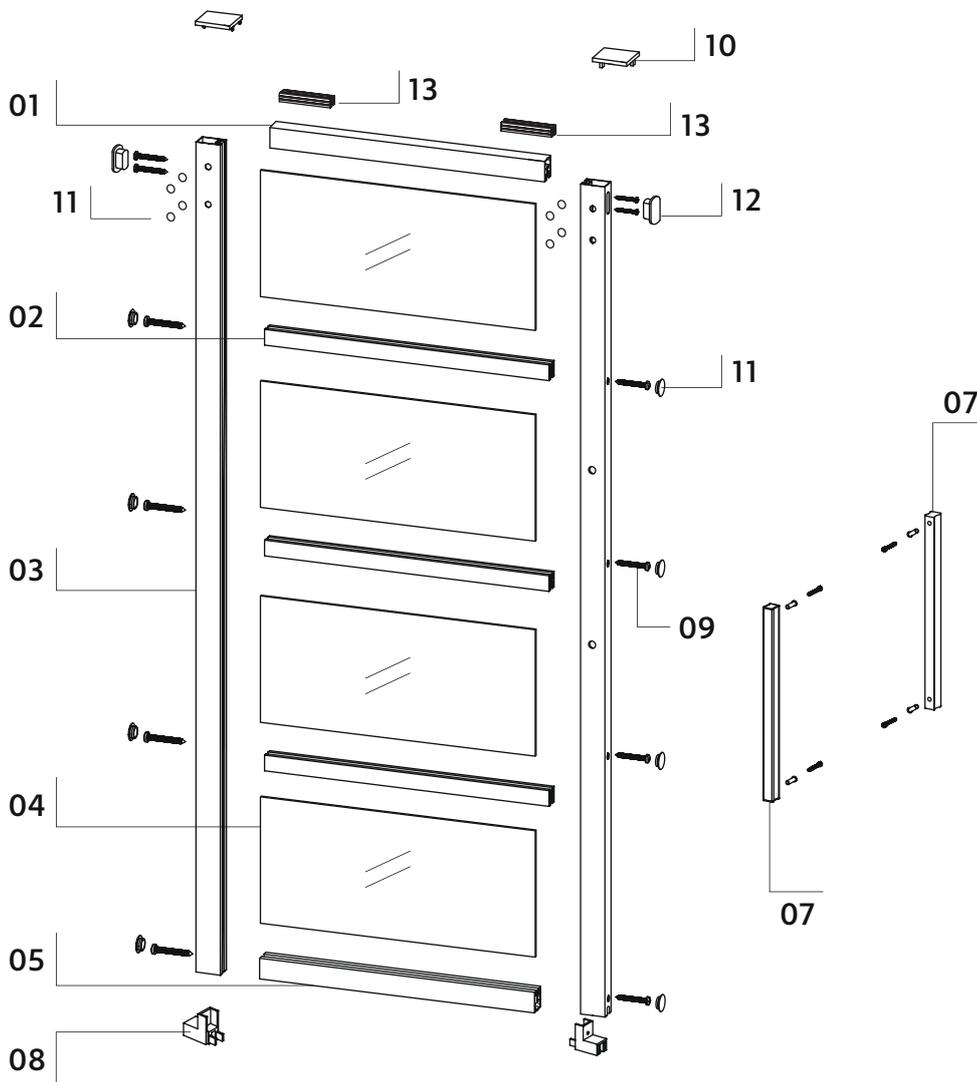
Deurgreep is zowel links als rechts op de deur te monteren. Bepaal voorafgaand aan de montage, aan welke kant de greep dient te komen.
