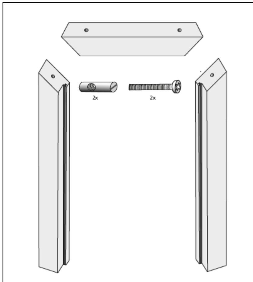
2. An die Stoßflächen von Längs- und Querteil Leim angeben und anschließend die Gewindegewinde mit dem Quermutterbolzen verschrauben.
