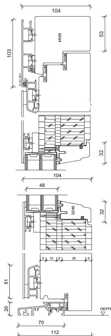
Abbildung: Schnitt AHT 3-105 Modern
