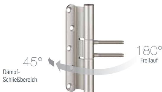
Variant SC (Self Close) ist ein innovatives Bandsystem, das gefälzte Türen selbstständig, gedämpft und kontrolliert schließen lässt. Die Tür wird einerseits beim Schließvorgang abgedämpft und durch eine selbsttätige Schließung ins Schloss geführt, während sie andererseits, wie gewohnt, im geöffneten Zustand stehen bleibt.
